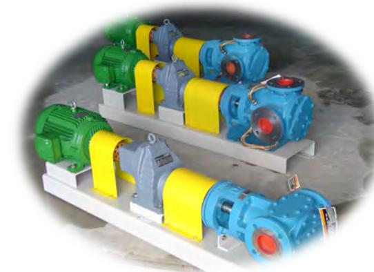
**VISCOSE** – Bomba GG em Ferro Fundido Especial para ABRASIVOS com Pino em Tungsten Carbide Sólido e Buchas em Silicon Carbide com Folgas especiais para Viscosidade de até 25.000 cps e Controle de End Clearance. Engaxetamento Especial Wedgee.
