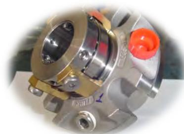
**MASSA DE CACAU E CHOCOLATE** – Bomba GG em Ferro Fundido Especial para ABRASIVOS com Pino em Tungsten Carbide Sólido e Buchas em Silicon Carbide com Folgas especiais para Viscosidade de até 150.000 cps e Controle de End Clearance. Engaxetamento Especial Wedgee.
