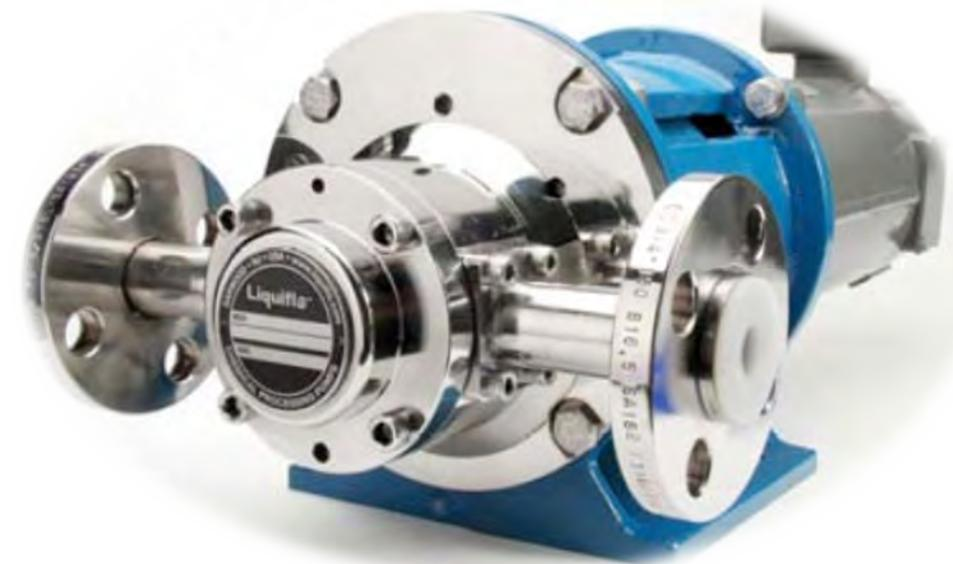
**SÉRIE “M” MAX™** As *Bombas de Engrenagens Magnéticas da Série MAX* são fabricadas a partir de *Blocos Maciços de Aço Inoxidável 316* possuindo portanto uma grande resistência mecânica e são equipadas com *Engrenagens de Dentes Helicoidais* permitindo assim atingir Pressões Diferenciais de até 23,80 barg. Fabricadas no conceito **HEAVY DUTY CONSTRUCTION** possuem eixos superdimensionados para minimizar flexão e são extremamente **SILENCIOSAS**.
